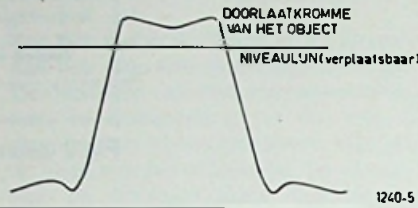
Fig. 5 DOORLAATKROMME MET NIVEAULIJN OP EEN OSCILLOSCOOP
